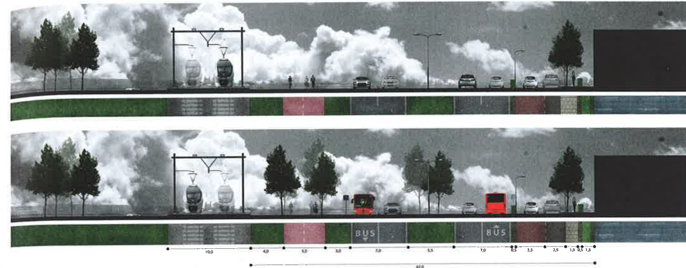
Huidig profiel: 2 x 2 banen asfalt voor auto (boven). Nieuw profiel: 2 x 2 banen asfalt, de helft voor de auto en de andere helft voor de metrobussen (onder)
