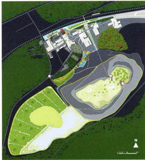
Het masterplan van Vista benadrukt de niveauverschillen tussen de industriële lagen. Linksonder het slibbassin met rechts daarvan de veertig meter hogere afvalberg. Bovenin het nulniveau met mijnschacht en station.
