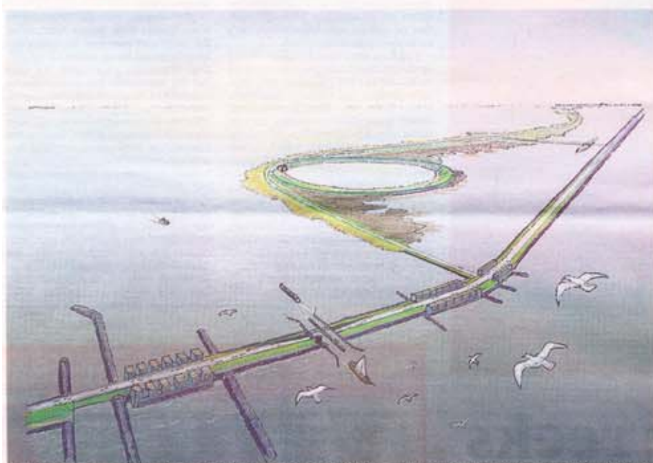
In het plan Monument in Balans (linksboven) wordt de dijk uitgerust met een stormschild en naviducten. In het plan Watermachine (rechtsboven) wordt de Afsluitdijk licht verhoogd en voorzien van zonnepanelen. Een tussenmeer moet het zoute water opvangen dat over de dijk slaat. Het plan WaddenWerken (rechtsonder) is de publieksleveling. Kwelders langs de dijk moeten golven breken en een groot natuurgebied vormen. In het plan Natuurlijk Afsluitdijk komt er een tweede dijk in het IJsselmeer en daartussen een 'valmeer' voor de opslag van duurzaam opgewekte energie. Illustraties Rijkswaterstaat
